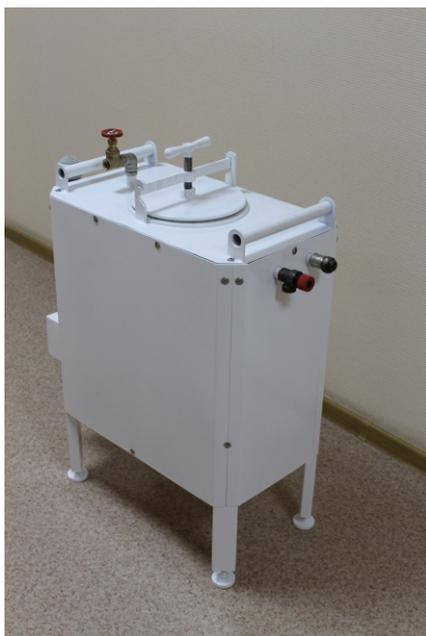
Все элементы парогенератора изготовлены из коррозионно-стойкой, жаростойкой и жаропрочной стали 12X18H10T с наружным декоративным полимерным покрытием. Парогенератор состоит из рабочей камеры и панели управления. Рабочая камера снабжена большой горловиной с герметичной крышкой. В камере имеются штуцеры для подвода воды, отвода пара, слива воды.
