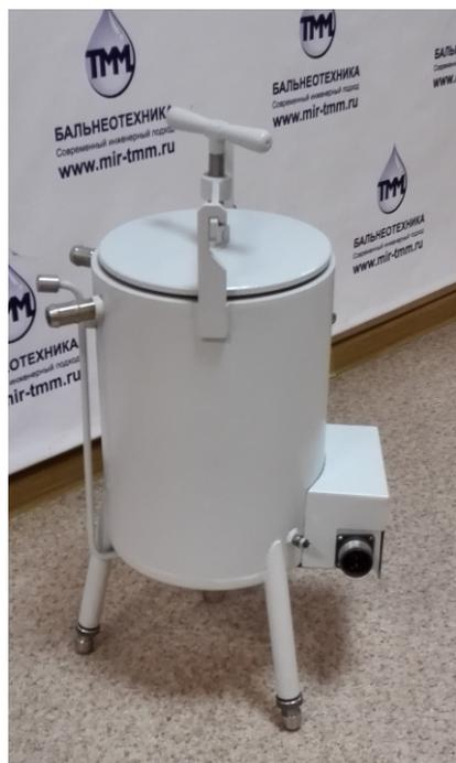
Конструкция парогенератора сварная, изготовленная из коррозионностойкой, жаростойкой и жаропрочной стали 12Х18Н10Т с применением аргонодуговой сварки. Парогенератор состоит из рабочей камеры, закрытой крышкой с зажимными устройствами и прокладкой. В камере имеются штуцеры для отвода пара, подвода сжатого воздуха, слива воды.
